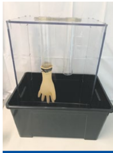
Testmaschine für Wasserhaltetest nach DIN 455 (links), intraoperativer Schaden am Zeigefinger eines OP-Handschuhs
