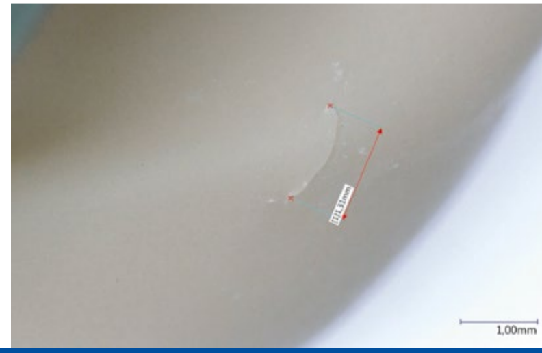
Testmaschine für Wasserhaltetest nach DIN 455 (links), intraoperativer Schaden am Zeigefinger eines OP-Handschuhs
